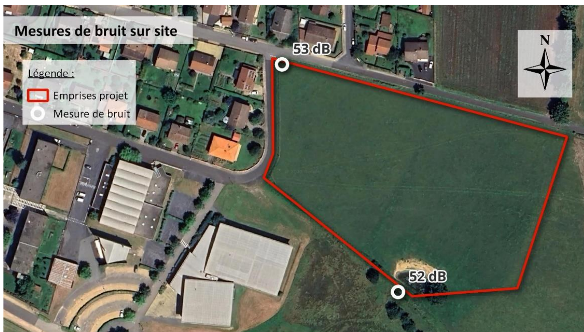
Illustration 29 : Mesures de bruit effectuées sur le site (source : État initial de l'étude d'impact, Réalités Environnement)
